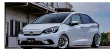
ホイールのナットホールはセンタープレートでカバード。その上にロックナットを模したキャップをセットすることで、1つのナットだけでホイールを取り付けたセンターロックホイールの装いを獲得しました。新機構「CLS」パッケージ。
